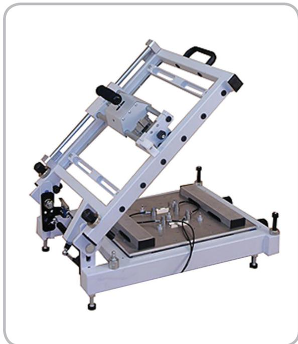
Предназначены для точного нанесения паяльной пасты в условиях опытного и мелкосерийного производства. Совмещение трафарета и платы производится при помощи специальных регулировок по осям X и Y. Принтеры имеют газовые фиксаторы, которые удерживают верхнюю раму в открытом состоянии.
